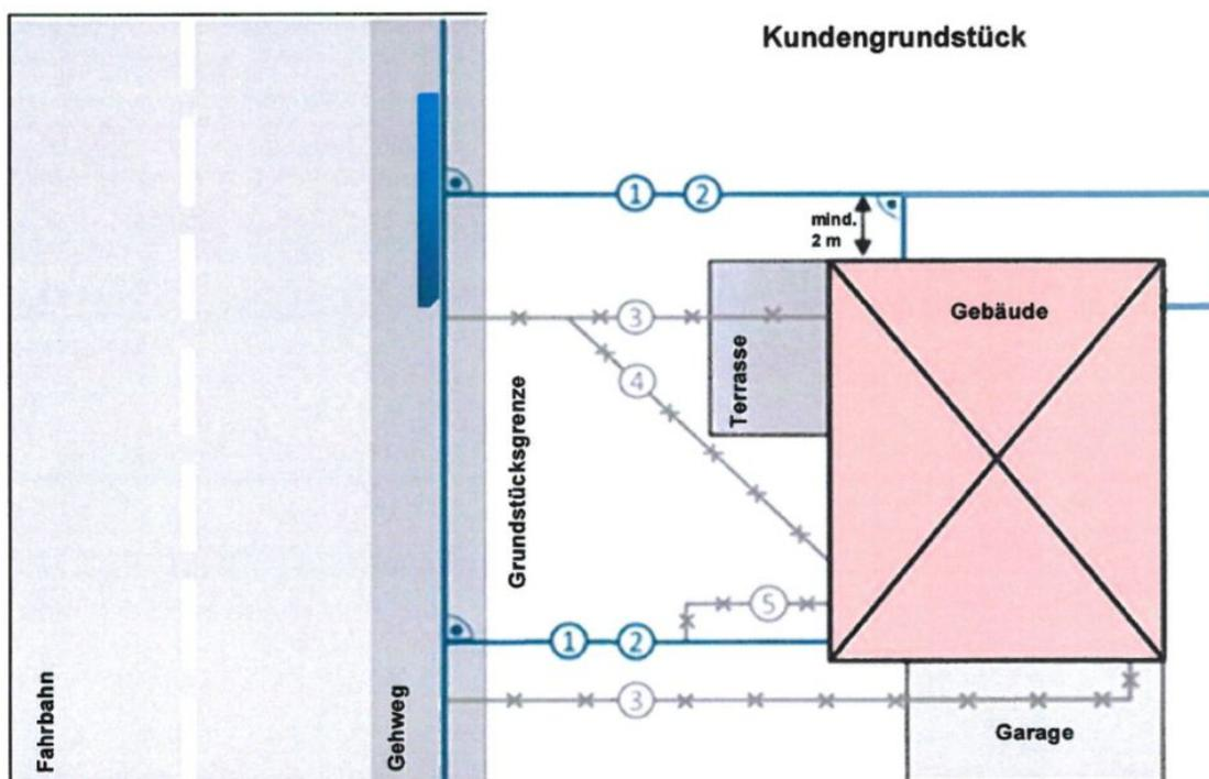
In allen von diesen Vorgaben abweichenden Fällen ist an der Grundstücksgrenze ein druckwasserdichter Wasserzählerschacht (siehe Werknorm WN225) zu errichten.
